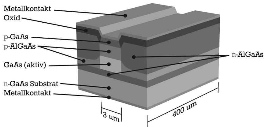
Abbildung 1.2.: Doppelheterostruktur eines GaAs/AIGaAs-Halbleiterlasers
