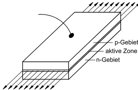
Abbildung 6: Schematische Darstellung eines einfachen Kanten-Emitter-Laser, der nur aus einem p- und einem n-dotierten Halbleiter besteht. Die Emission findet durch die teilreflektierenden Kanten statt [7].
