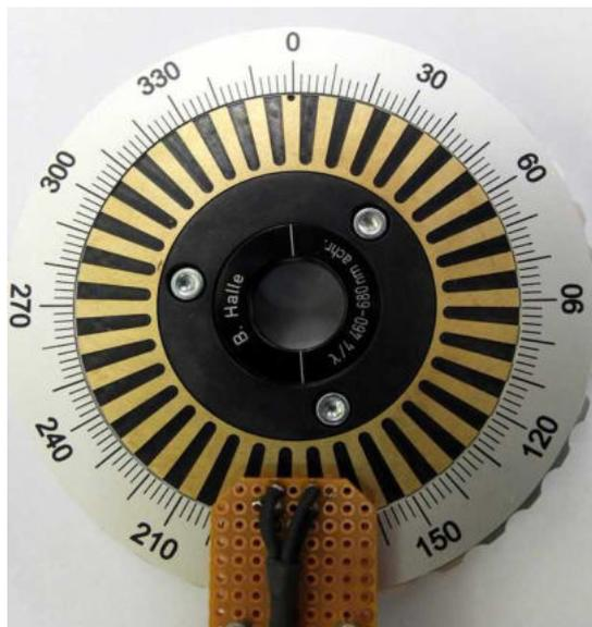
Abbildung 12: Foto des im Versuch verwendeten Drehwinkelaufnehmers mit der in verschiedenen stark reflektierende Zonen eingeteilten Kreisscheibe. Eingebaut ist ein  $\lambda/4$ -Platte, markiert ist die Richtung der schnellen Achse.
