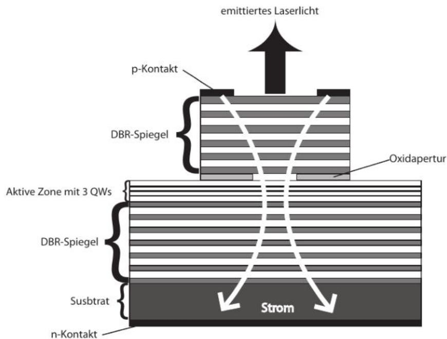
Abbildung 7: Schematischer Aufbau eines VCSEL (Quelle: Diplomarbeit von Andreas Molitor)
