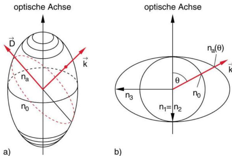
**Abb. 8.31.** (a) Rotationssymmetrisches Indexellipsoid mit der Symmetrieachse in Richtung der optischen Achse. (b) Zweidimensionale Darstellung von  $n_a(\theta)$  und der nicht von  $\theta$  abhängigen Größe  $n_0$  für einen positiv einachsigen Kristall
