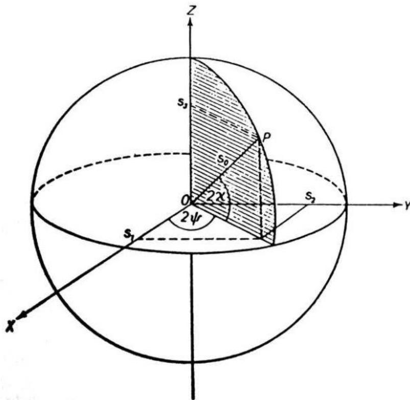
Abbildung 2: Poincaré Sphäre: Die Punkte auf der Kugeloberfläche können sowohl durch die Stokes-Parameter als auch durch die elliptischen Parameter dargestellt werden.
