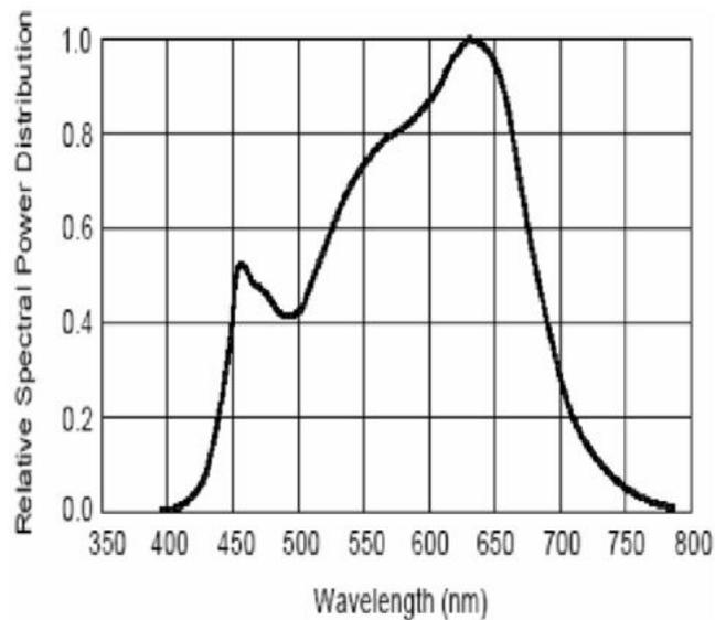
Abbildung 13: Spektrum der M57L5111 LED; Quelle: Datenblatt
