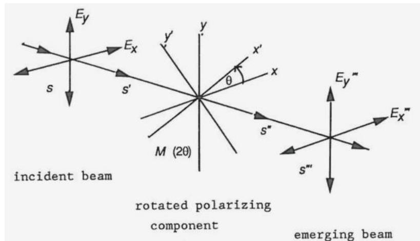
Abbildung 3: Definition der Koordinatenachsen und Drehwinkel für die Berechnung der Müller-Matrix gedrehter Elemente. Abbildung aus [3, S.80]. Der Drehwinkel  $\alpha$  ist hier als  $\theta$  bezeichnet.
