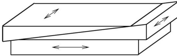
Abbildung 2: Die Richtung der optischen Achsen im SOLEIL'schen Kompensator.
