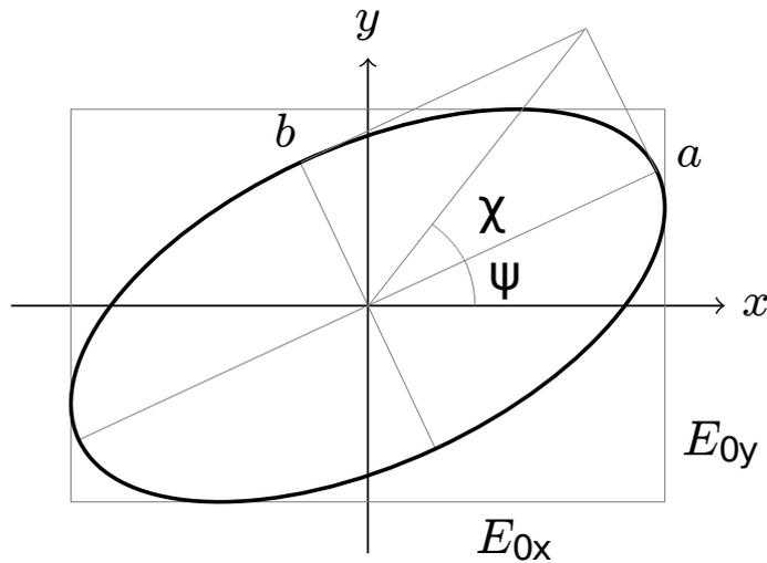
Abbildung 1: Polarisationsellipse für  $E_{0x} = 3, E_{0y} = 2$  und  $\delta = 60^\circ$
