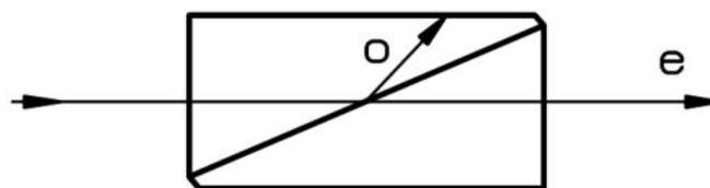
Abbildung 8: Schemaskizze eines Glan-Thompson-Polarisators (Quelle: Datenblatt des Polarisators)
