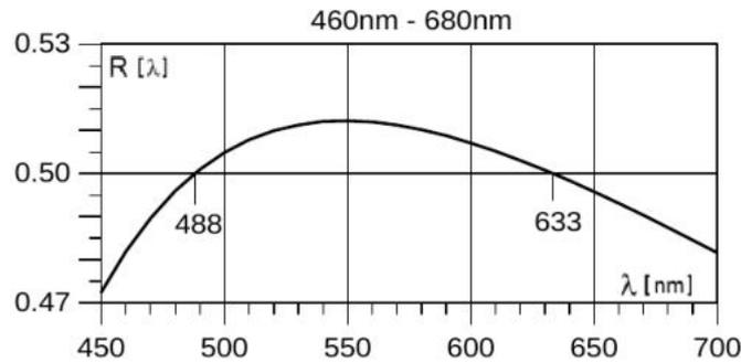
Abbildung 9: Verzögerung in Einheiten von  $\pi$  als Funktion der Wellenlänge für ein achromatisches Verzögerungsplättchen (Quelle: Datenblatt)
