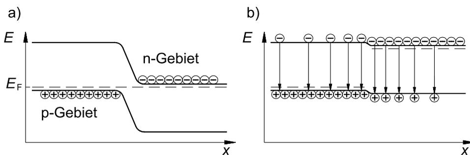
Abbildung 5: Energiebänder in einem pn-Übergang ohne (a) bzw. mit angelegter Spannung (b) [7]
