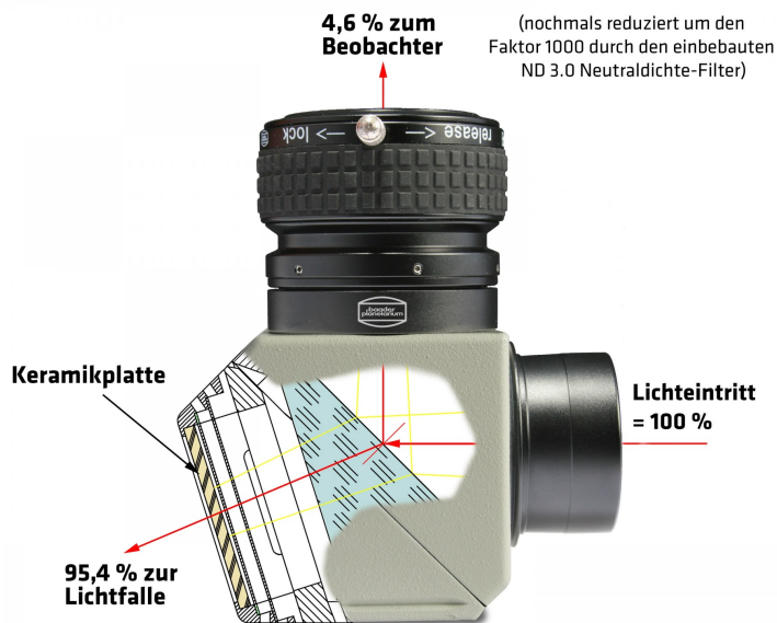
Abbildung 5: Skizze des Herschel-Keils der Firma Baader Planetarium, der für die Beobachtungen eingesetzt wird [Quelle: Baader Planetarium].
