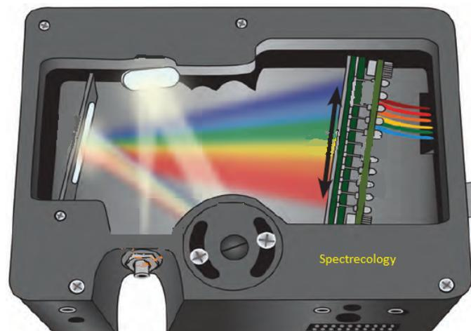
Figure 2.6.: Aufbau des im Versuch eingesetzten Gitterspektrometers.
