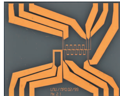
Abb. 3: Experimentell lassen sich Atom-Chips in Form integrierter Leiterbahnstrukturen auf der Oberfläche eines Trägersubstrats für verschiedene Magnetfallen herstellen (oben, Foto: J. Reichel, München/Paris). Links sieht man einen Gesamtaufbau mit dem am oberen Ende auf einem Vakuumflansch montierten Atom-Chip. (Foto: J. Schmiedmayer, Heidelberg)
